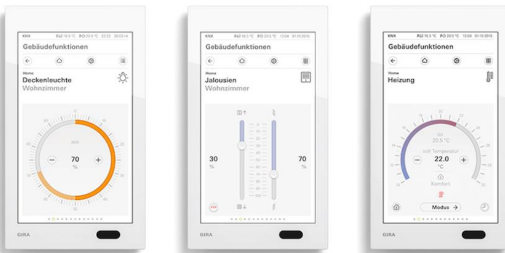
Abbildung 3: Touch Panel Interfaceelemente (Dimmen, Jalousie, Heizung) [19]
